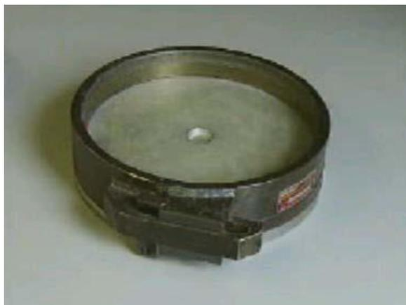
2. Collocare sul disco inferiore l'anello di acciaio in posizione aperta.
