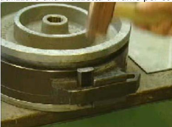
18. Utilizzare l'estrattore in dotazione con la staffa per rimuovere il disco superiore in alluminio.
