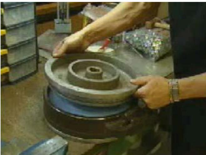
14. Chiudere l'anello di acciaio. A tale scopo inserire il cuneo come mostrato in figura e utilizzare una mazzetta di rame per colpire il cuneo e chiudere l'anello.
