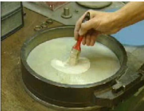
Attenzione: l'utilizzo di un talco contenente sostanze inquinanti può contaminare la gomma durante il processo di vulcanizzazione pregiudicando sia le caratteristiche fisiche sia quelle chimiche della gomma stessa.
