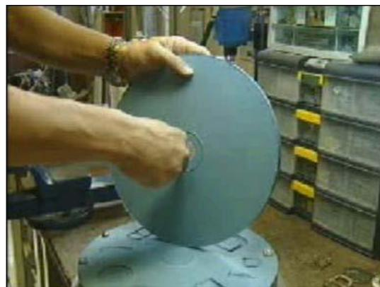
20. Intagliare lo stampo in gomma ricavando i canali di adduzione del metallo fuso e i canali di sfogo dell'aria.
