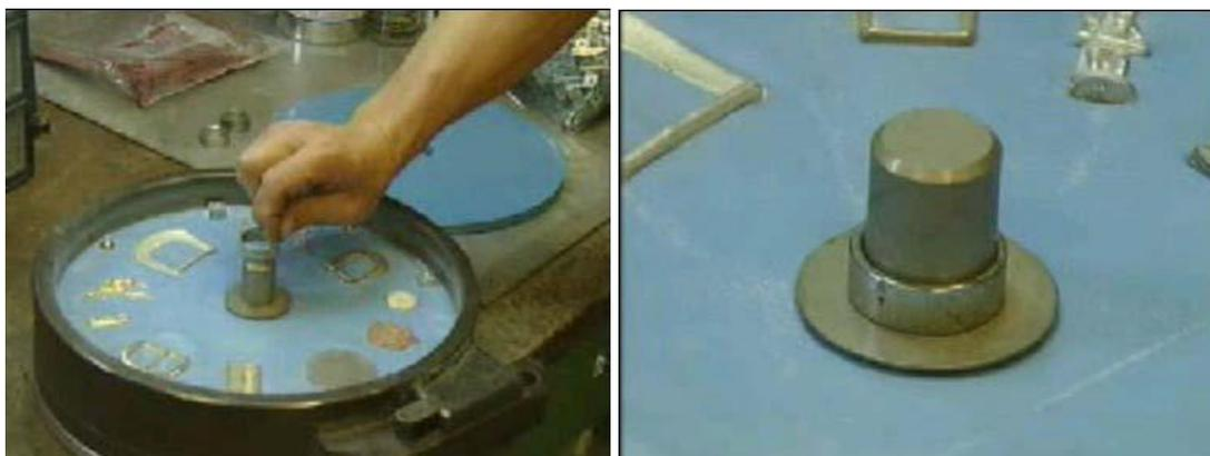
10. Inserire il disco di gomma superiore (quello con il foro) all'interno della staffa; con le dita fare aderire delicatamente la gomma a quella inferiore e ai modelli.
