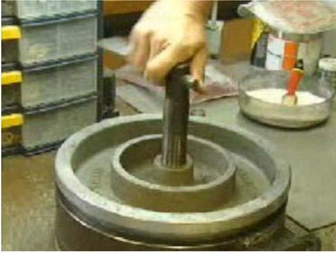
19. Utilizzare il bisturi per ricavare un foro di diametro compreso tra 50 e 60 mm nella gomma superiore.
