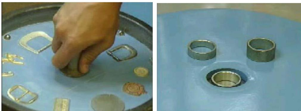
9. Prendere l'anello distanziale e inserirlo nel fungo centrale. Attenzione: utilizzare l'anello distanziale avente la stessa altezza dello spessore della gomma superiore.
